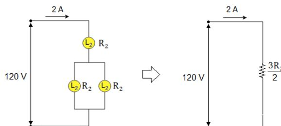
Então, aplicando a primeira lei de Ohm:  $U = \frac{3R_2}{2} \cdot i \Rightarrow 120 = \frac{3R_2}{2} \cdot 2 \Rightarrow R_2 = 40 \Omega \quad (1 \text{ ponto})$
